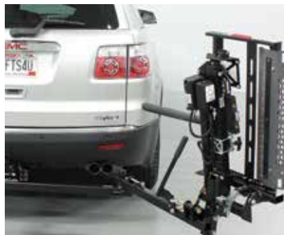
Swing-Away: Se gira para dar acceso fácil al compartimento o al área de carga.
