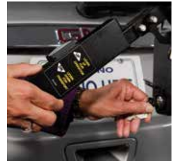
Control de un solo botón con pestillo de seguridad para evitar que la plataforma descienda de manera no intencional.
